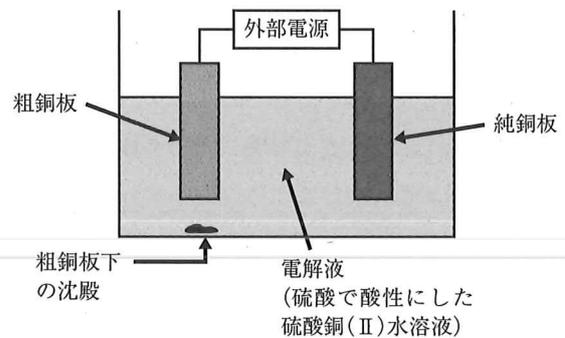
図1. 銅の電解精錬の原理
